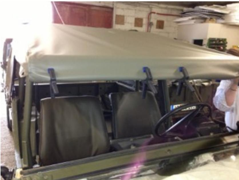
Die Windschutzscheibe kann hierbei zur Arbeitserleichterung weggeklappt werden. Bitte unbedingt darauf achten, dass die Plane auch mittig gleichmässig gespannt ist. Nun noch eine Markierung für die Mitte sowohl auf die Plane, als auch auf die innere Unterkante des Spiegels anbringen.
