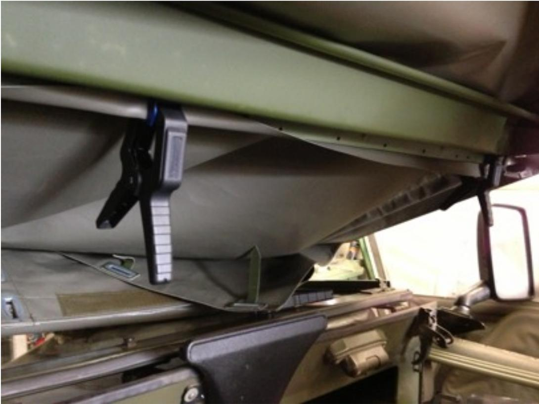
Beim durchstoßen der Löcher unbedingt darauf achten, dass nur die INNERE Lage der Plane durchstoßen wird. Keinesfalls darf die Plane hinter dem Spiegel noch ein mal durchbohrt werden! *Alternativ können die Löcher auch von der Rückseite angezeichnet werden und dann mit einer Lochzange in die Plane geknipst werden.*
