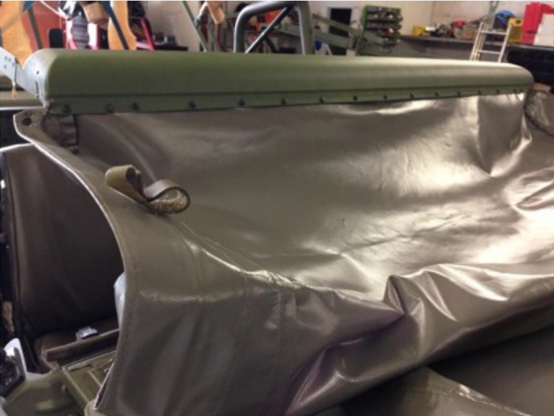
Dann wird die Plane wieder nach hinten über das Verdeckgestell gestülpt und in den Schlitzösen sowie innen mit den Klettverschlüssen befestigt. Leichte Falten verschwinden meist nach ein paar Tagen in der Sonne, da das Material noch etwas schrumpft. Die 2 Finger breit Platz, der zu Anfang beim Anpassen der Plane zwischen Spriegel und Scheibenrahmen gelassen wurden, sorgen nun beim Schließen der Verdeckhaken am oberen Scheibenrahmen für eine ausreichende Spannung des Verdeckes.
