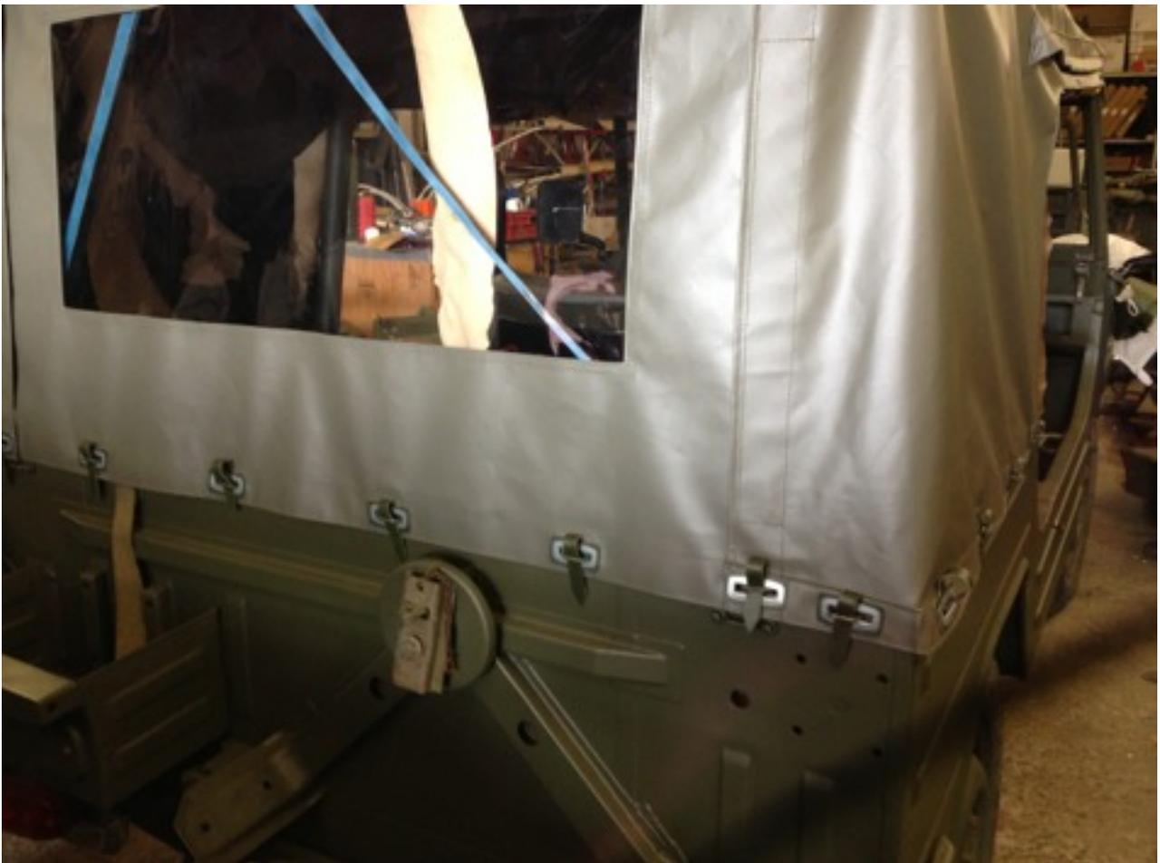
Die hintere Naht über der Heckklappe sollte jetzt etwa auf der Rundung der hinteren, oberen Stange des Verdeckgestänges liegen
