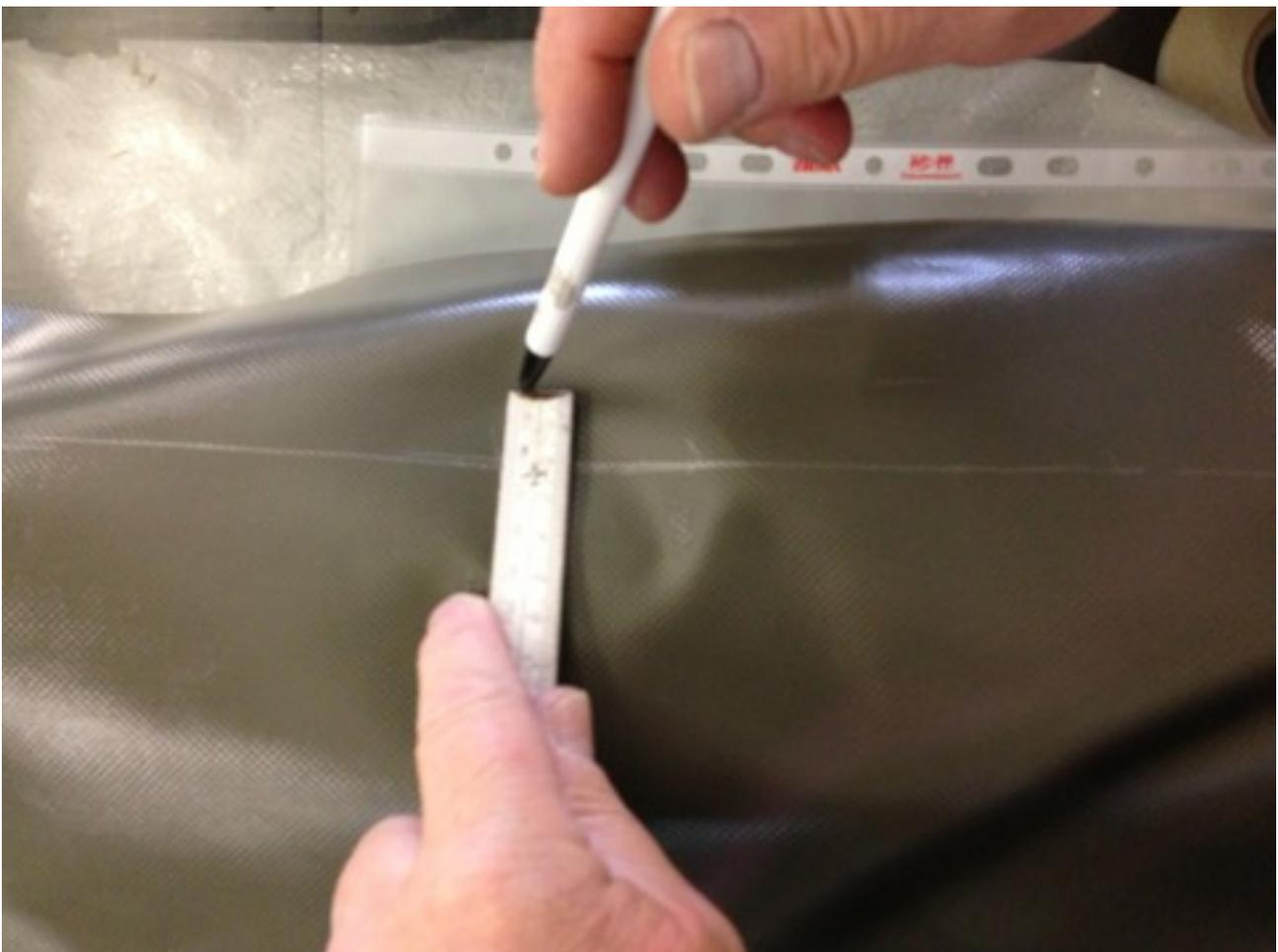
Entlang dieser eingezeichneten Zugabe wird die Plane nun abgeschnitten.
